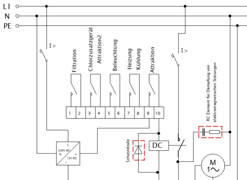
Dies ist der empfohlene Ausgangsanschluss des Vario DIN-Moduls für den Anschluss einer induktiven Last in einer Leistungsschalterbox (das Diagramm gilt für einen Ausgang = in diesem Fall der Kontakt „Attraktion“). Verbinden Sie die anderen Ausgänge entsprechend mit induktiver Last.
