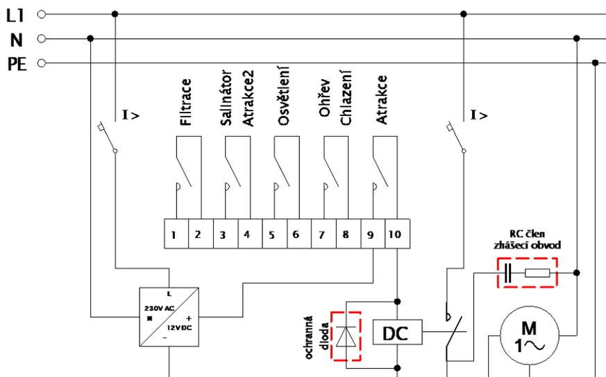
**Doporučené zapojení výstupů VARIO DIN modulu při připojení indukční zátěže v rozvaděči. Vzorové schéma platí pro jeden výstup = v tomto případě kontakt "Atrakce". Obdobně doporučujeme použít pro všechny výstupy s indukční zátěží.**
