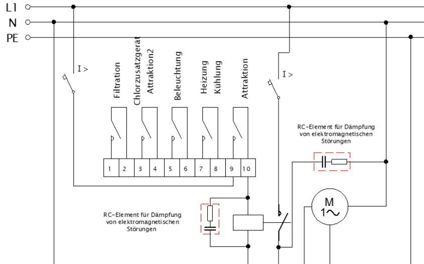
**Verbindungsschema der DC Relaisspule:**
