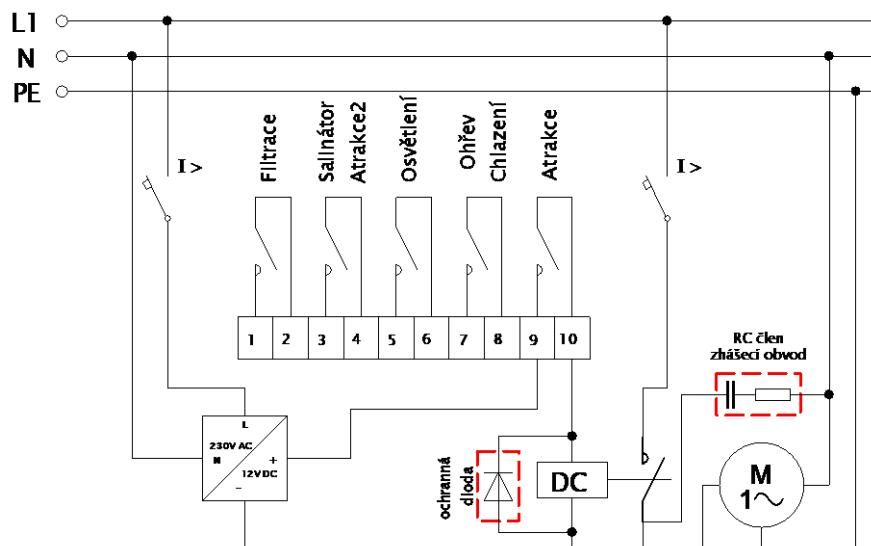
**Рекомендуемое подключение выходов DIN модуля Vario при подключении индуктивной нагрузки к распределительному щиту (примерная схема относится к одному выходу = в этом случае контакт «Аттракцион»). Аналогичным образом, мы рекомендуем использовать его для всех выходов с индуктивной нагрузкой.**
