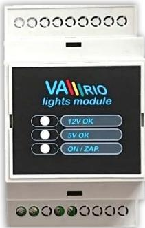
Přídavný modul DIN LIGHTS pro řízení světel
