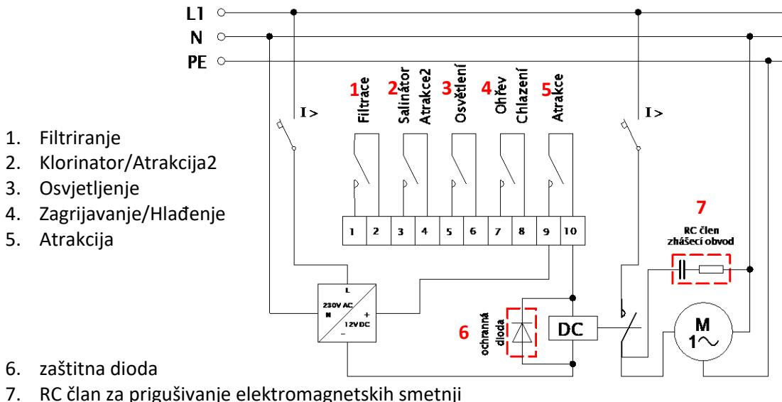
Ovo je preporučeno spajanje izlaza Vario DIN modula pri spajanju induktivnih opterećenja unutar glavnog razvodnika (shema se odnosi na jedan izlaz = u ovom slučaju kontakt „Atrakcija“. Isto tako preporučujemo da se koristi za sve izlaze s induktivnim opterećenjem.
