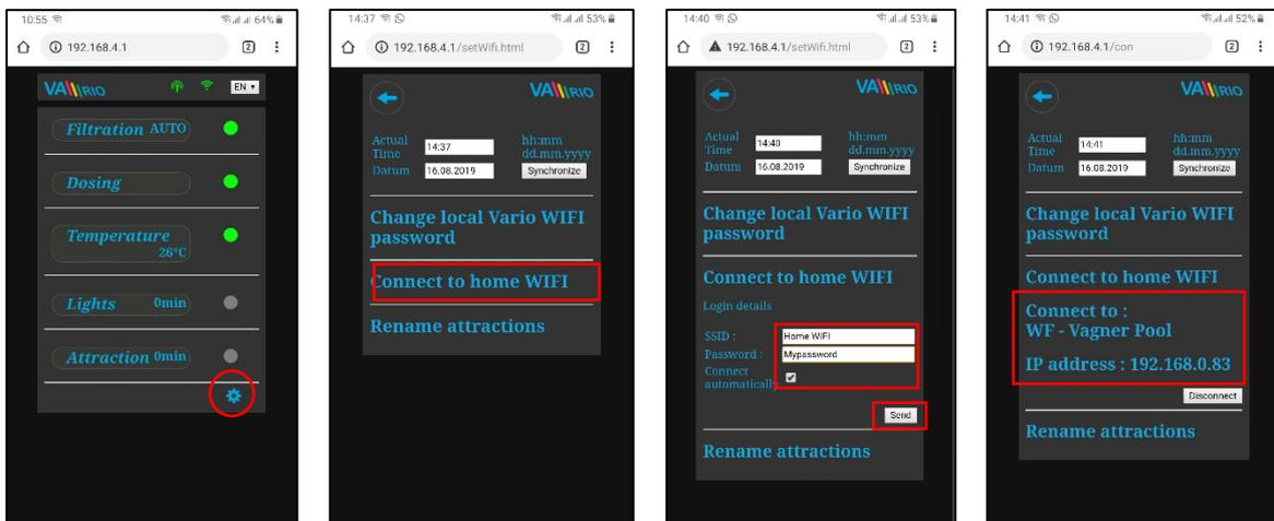
5. Nach dem Anschließen des WIFI-Moduls an Ihr Heim-WLAN-Netzwerk, **trennen Sie die Verbindung zum lokalen VARIO-WLAN-Netzwerk (WFxxxx) und stellen Sie über Heim-WLAN oder mobile Daten erneut eine Verbindung zum Internet her.**
