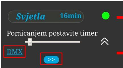
Tipka **DMX** otvara izbornik za napredno upravljanje osvjetljenjem preko komunikacije DMX
