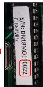
7. Po úspěšném spárování DIN a WIFI modulu (zadání správného sériového čísla) se zobrazí ovládací stránka s aktuálními stavy výstupů. V případě chybného zadání se jednotka pokusí připojit, nicméně díky tomu, že nemá odezvu od DIN modulu, nabídne opětovné zadání sériového čísla.
