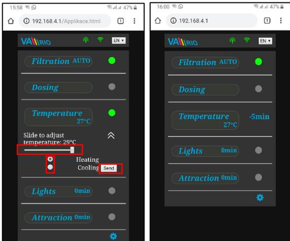
Ausgang des R4 Moduls aus dem DIN Modul kann aufs Regime „**Heizung**“ hinsichtlich der aktuellen Temperatur (in diesem Fall) oder aufs Regime „**Kühlung**“ eingestellt werden.
