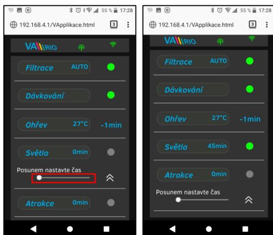
Izlaz R3 iz DIN modula omogućava uključivanje osvjetljenja bazena u vremenskom intervalu (+5 min) u rasponu od 0-240 minuta.
