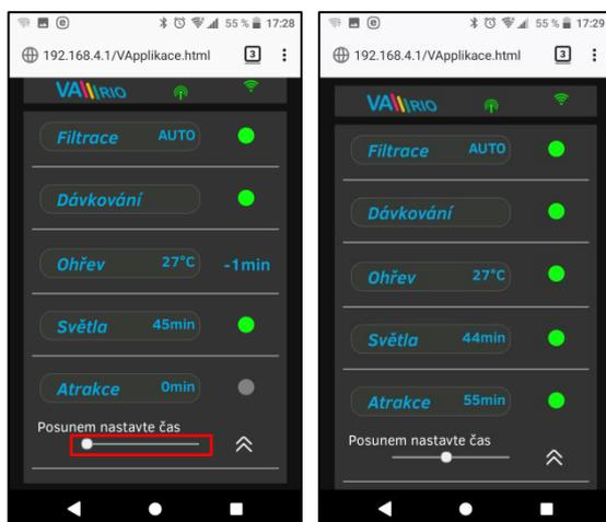
Izlaz R5 iz DIN modula omogućava uključivanje atrakcije u vremenskom intervalu (+5 min) u rasponu od 0-120 minuta (na isti je način moguće postaviti izlaz R2 – režim ATRAKCIJA2).
