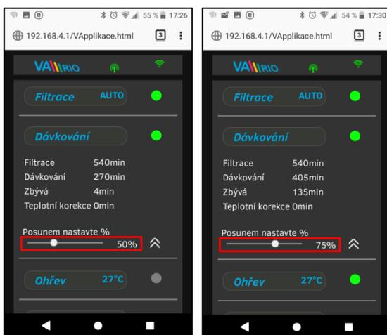
Výstup R2 modulu DIN modul může být nakonfigurován na režim “Dávkování” s ohledem na filtrační dobu (tento případ) nebo na režim “Atrakce2”.
