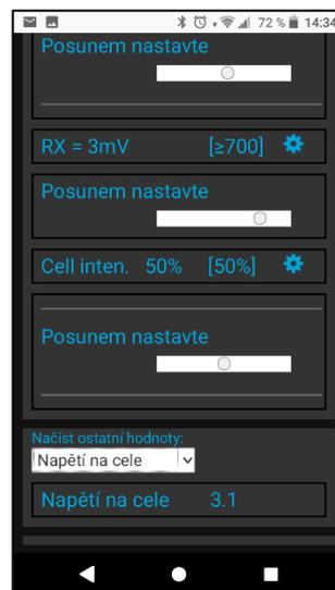
Gore navedene izmjene i postavke vrijede za parametar pH. Na isti ćete način izvršiti izmjene željene vrijednosti ili statusa alarma za parametre Klor (CL), odnosno redox (RX). Prikaz saliniteta moguć je jedino u slučaju ako je na stanicu za doziranje spojen senzor saliniteta. Unaprijed određena lozinka za izmjene je **“1234”**.
