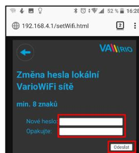
**TIP:** Ne zobrazí-li se stránka 192.168.4.1, zkuste na Vašem zařízení vypnout mobilní data. Při současně zapnutých datech se zařízení snaží připojit přes internet, a ne přes lokální síť VARIO.
