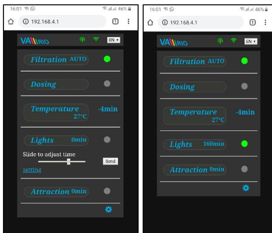
Ausgang R3 aus dem DIN Modul ermöglicht Einschaltung der Schwimmbadbeleuchtung in der Zeitspanne (+5 min) von 0-240 Minuten.
