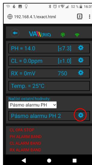
Navedene izmjene i postavke vrijede za parametre pH. Na isti ćete način izvršiti izmjene željenih vrijednosti ili statusa alarma za parametre klor (CL), odnosno redoks (RX). Zadana lozinka za izmjene je "1234".
