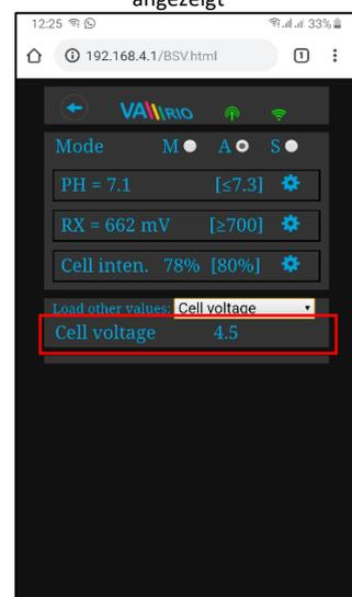
Die obigen Einstellungen und Anpassungen sind für den pH-Parameter verfügbar. Stellen Sie die CL-, RX-Werte oder Alarmbänder auf die gleiche Weise ein. Der Salzgehalt kann nur angezeigt werden, wenn ein Salzgehaltssensor angeschlossen ist. Das Standardpasswort für alle Einstellungen lautet „1234“.
