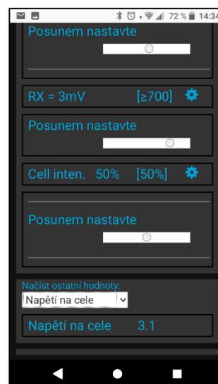
Výše uvedené změny a nastavení platí pro parametr pH. Stejným způsobem provedete změnu požadované hodnoty nebo alarmového stavu parametru Chlor (CL), resp. Redox (RX). Zobrazení salinity je k dispozici pouze v případě připojeného senzoru salinity k úpravě slané vody. Defaultní heslo pro změny je "1234".
