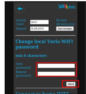
**TIPP:** Wenn die Seite 192.168.4.1 nicht geöffnet wird, deaktivieren Sie die mobilen Daten auf Ihrem Gerät. Bei gleichzeitig aktivierten mobilen Daten versucht Ihr Gerät, eine Verbindung über das Internet herzustellen.
