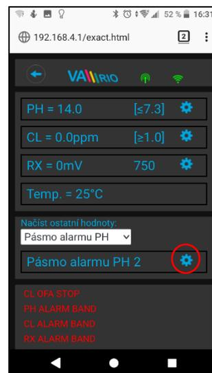
Výše uvedené změny a nastavení platí pro parametr pH. Stejným způsobem provedete změnu požadované hodnoty nebo alarmového stavu parametru Chlor (CL), resp. Redox (RX). Defaultní heslo pro změny je **“1234”**.
