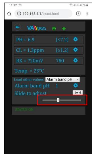
Angeführte Änderungen und Einstellungen gelten für pH-Parameter. Ebenso werden gewünschte Werte oder Alarmstatus für Parameter Chlor (CL), bzw. Redox (RX) geändert. Das Standardkennwort für Dosierungsanpassungen lautet „1234“.
