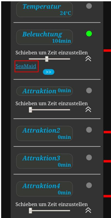
Über das Bedienfeld „Lichter“ kann der Benutzer entweder Lichter ohne DMX-Kommunikation (SeaMaid, RGB Flat) oder Lichter mit DMX-Kommunikation (Adagio Pro, Hugo Lahme, Wibre) steuern. Rufen Sie das Steuerungsmenü auf, indem Sie die DMX-Taste (SeaMaid / RGB Flat) drücken. Steuerfunktionen sind unten.
