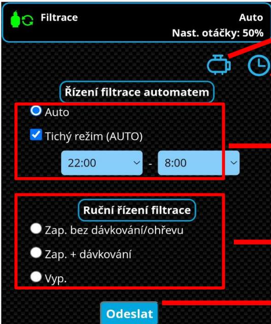
**Otáčky čerpadla** – Nastavení otáček motoru v různých režimech filtrace. Pouze s modulem DIN PUMPS.
