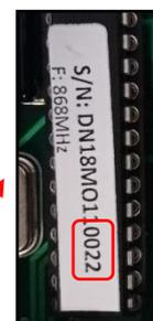
7. Nakon uspješnog uparivanja modula DIN i WIFI (unošenje ispravnog serijskog broja), prikazat će se upravljačka stranica s aktualnim stanjem izlaza. U slučaju pogrešno unesenog serijskog broja jedinica se pokušava spojiti, a zbog toga što nema odaziva, nudi mogućnost ponovnog unosa serijskog broja.
